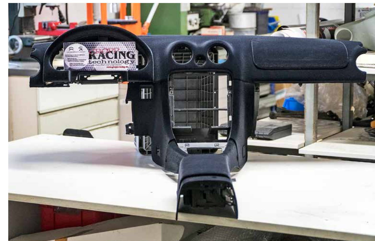
Beflockung vom Armaturenbrett: Eine Spezialität von Uwe Gropps kleiner aber feiner Rennsport-Schmiede
